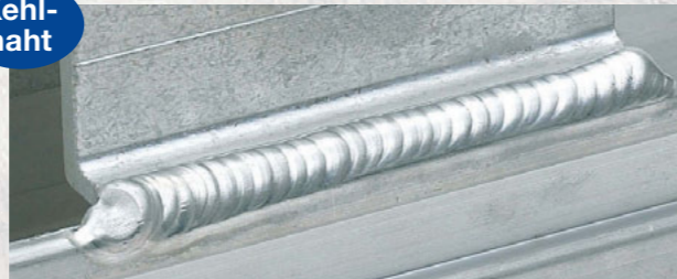
Schweißstrom 130 A, AC-Frequenz 150 Hz, Geschwindigkeit 25 cm/min, Blechdicke 3 mm
