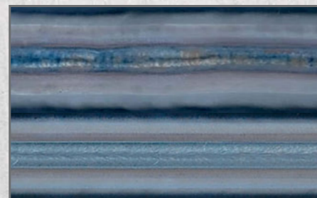
Vergleich Verwendung „herkömmliche Düsentechnik“ (oben) und „OTC Doppeldüsentechnik“ (unten)
