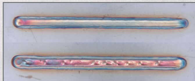
Vergleich „analoge Gasregelung“ und „digitale OTC Gasregelung“ (oben)
