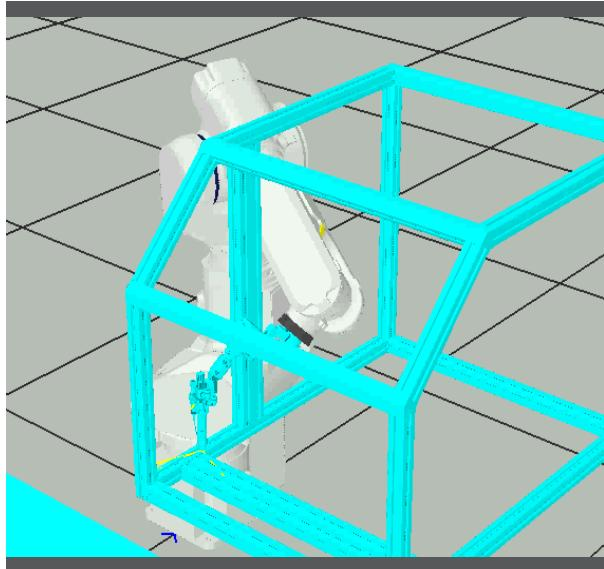
Mit der typischen 6-Achs-Kinematik ist es schwierig bis unmöglich, in enge Bauteile einzutauchen.
