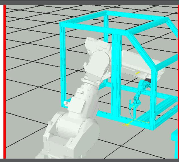
Der erweiterte Freiheitsgrad ermöglicht eine konstante Brennerorientierung beim Eintauchen in enge Arbeitsräume.
